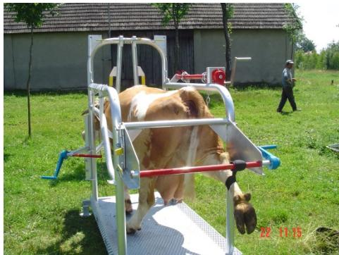
Конструкция станка изготовлена из высококачественной и прочной стали для защиты от коррозии покрываются слоем цинка 65-70 мк. по ГОСТ 9.307-89. На покрытие выдается сертификат качества. Для фиксации ног предусмотрен механизм лебёдок. Габариты: высота 195 см; длина 245 см; ширина 110 см.; вес 260 кг.
