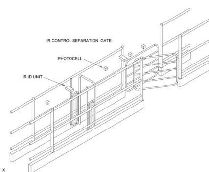
Модуль управления селекционными воротами (2x направлений) для автоматической селекции коров согласно различным критериям.
